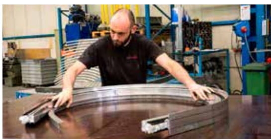
Photo 3 : insertion de parclose dans une fenêtre cintrée
