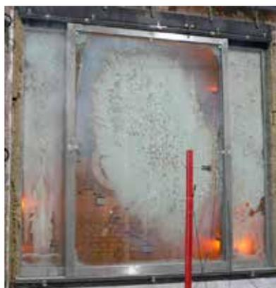
*Réaction vitrages Rf (Vitrage - EI)*
