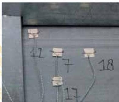
I<sub>1</sub> : Thermocouples 12 à 25 mm
