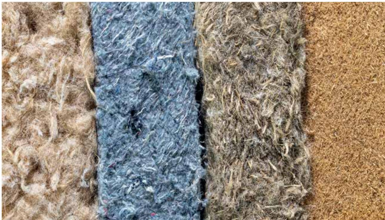
Exemples de matériaux d'isolation souples et poreux biosourcés : fibres de lin, fibres textiles, fibres d'herbe et fibres de bois.
