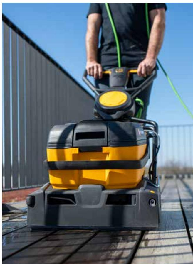
plancher lisse. Avec l'autolaveuse Turbo Scrubber, plus besoin de poncer. Un nettoyage rigoureux en profondeur à l'autolaveuse permet de conserver totalement l'aspect du bois ancien.
