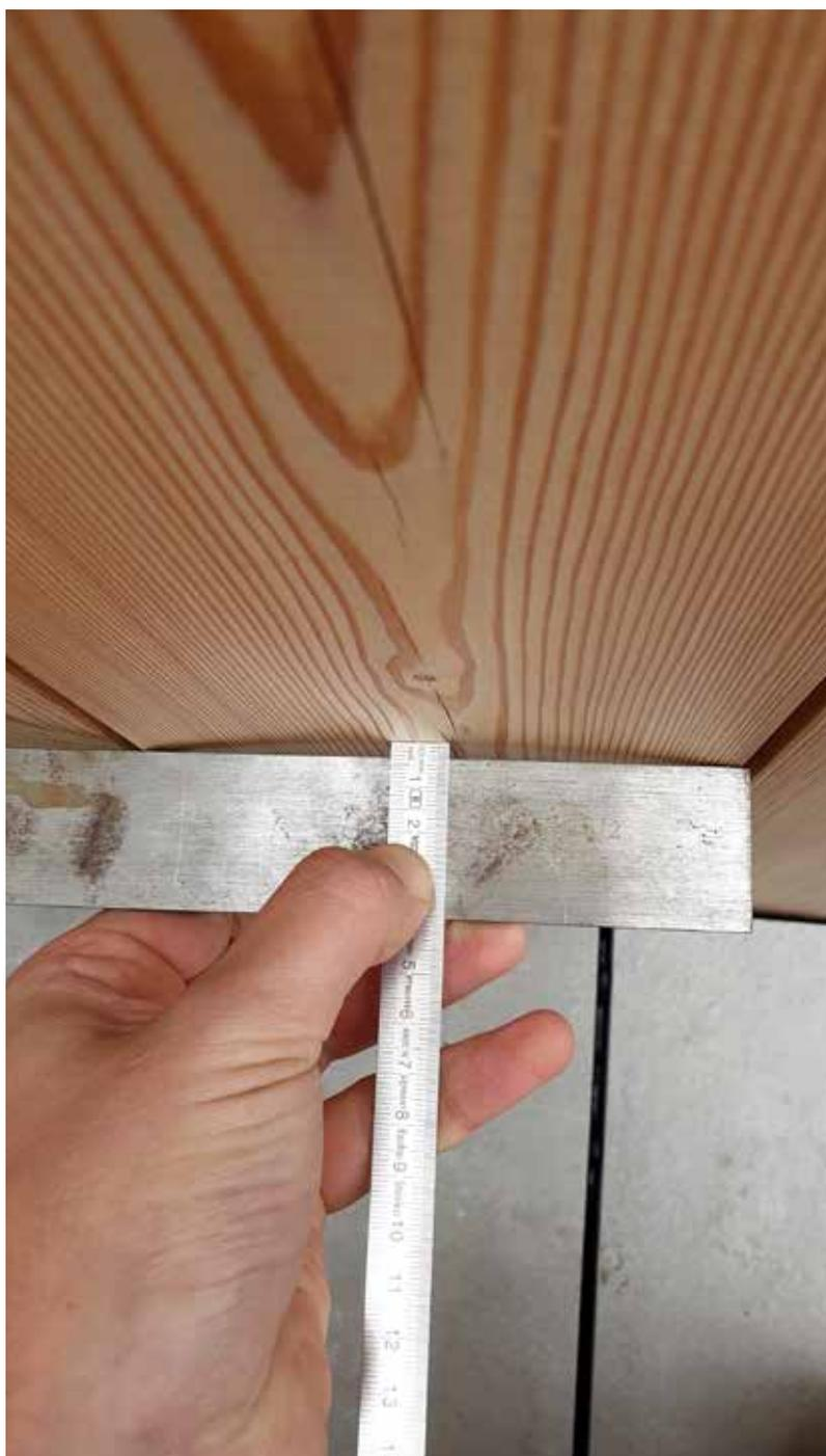
Cintrage de 3 à 4 mm sur la largeur des lames du bardage en bois.
