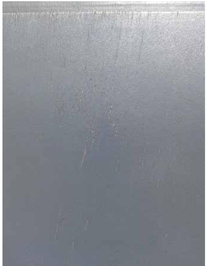
**Finition ponctuée : Peinture grise de finition dans laquelle on aperçoit des ponctuations blanches, celles-ci étant les futurs points d'entrée d'eau à l'origine des décollements de film .**
