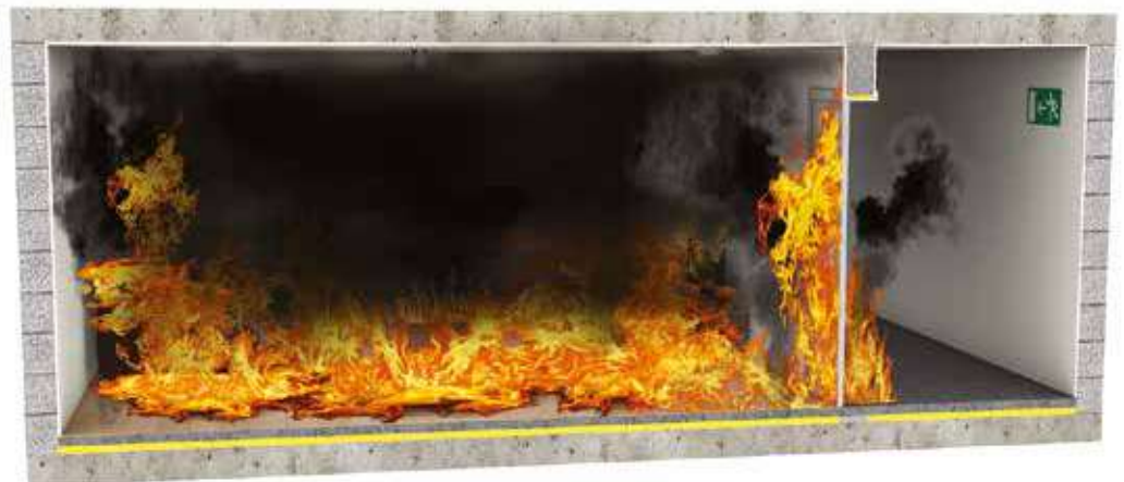
fig. 4 | Propagation de l'incendie au compartiment adjacent
