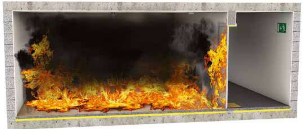
fig. 4 | Propagation de l'incendie au compartiment adjacent
