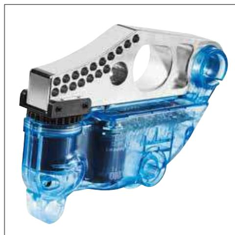
Lors de la détection du contact avec la peau, une cartouche libère un ressort et projette un bloc d'aluminium dans la lame de la scie. Le tout se passe en un rien de temps : en à peine 5 milli-secondes, la lame est arrêtée et disparaît totalement sous la zone de danger ! À titre d'exemple, c'est 10 fois plus rapide qu'un airbag de voiture.
