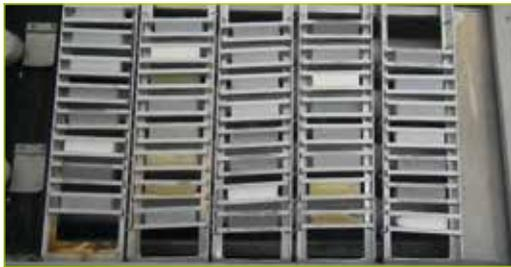
A. Éprouvettes en cours de vieillissement sous l'effet de rayonnements UV et de variations d'humidité.
