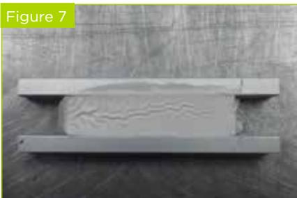
Formation de plissures après vieillissement sous rayonnements UV et variations d'humidité.
