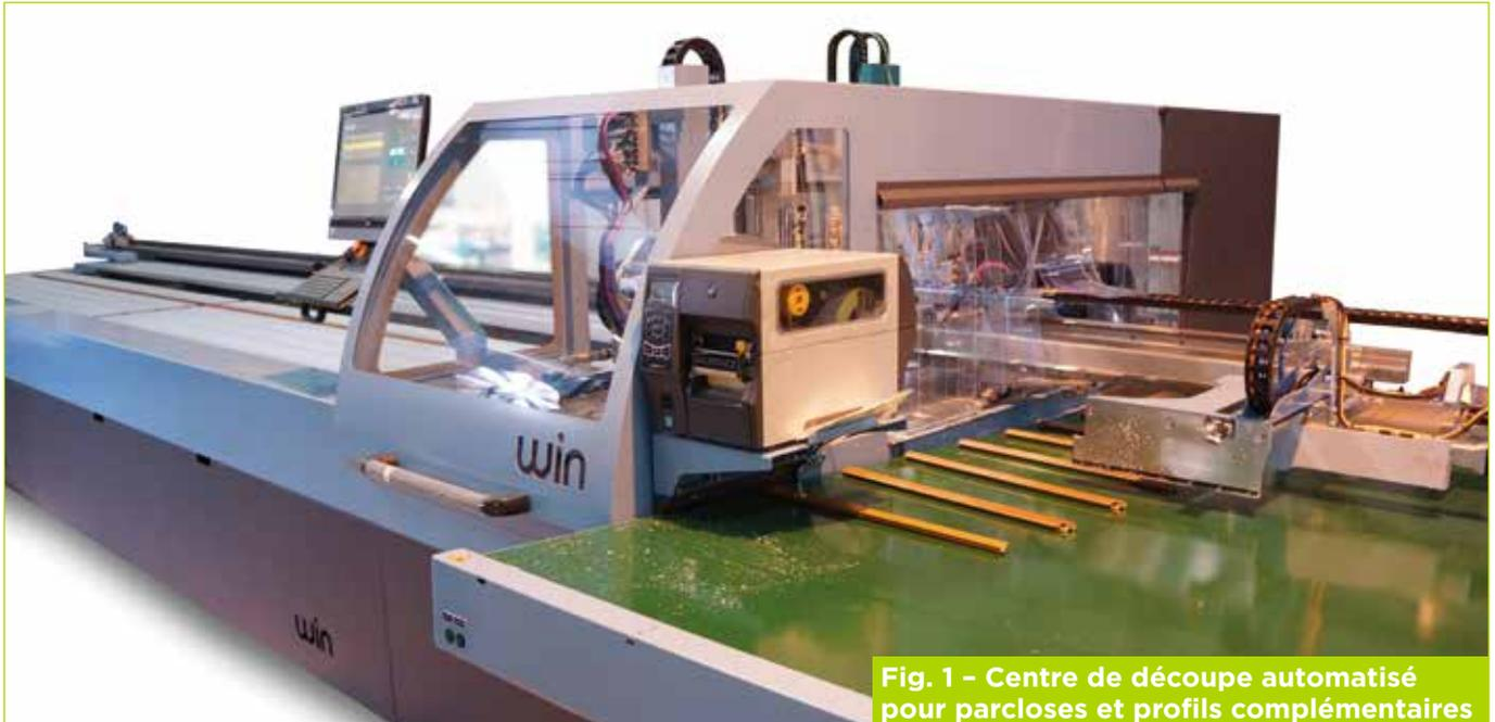
**Fig. 1 - Centre de découpe automatisé pour parcloles et profils complémentaires**
